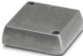
DUPLICON, алюминиевая крышка корпуса, тип B6, степень защиты IP67, с двумя невыпадающими винтами M3, V2A, уплотнение и отверстие для шнура, закрепление самонарезающими винтами M3
