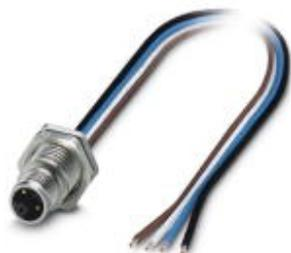
Встраиваемые разъемы, Мощность, 4-полюсн., Штекеры, M12, L - Power, Монтаж с внутренней стороны, M16 x 1,5, Отдельные проводники, длина кабеля: 0,2 м
