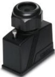
Сальниковый корпус, пластиковый, конструкция: VC2, черный, со встроенным кабельным вводом диаметром от 10 до 25 мм, крепежные винты с внутренней шестигранной головкой из V2A.
