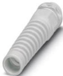
Кабельный ввод, материал резьбового соединения: PA, применение: Стандартн., наружный диаметр кабеля 4,5 мм ... 10 мм, экранировка: нет, резьба соединительной части: M16 x 1,5, цвет: светло-серый, RAL 7035, с защитой от излома
