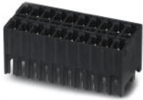
Корпусная часть для печатных плат, номинальный ток: 8 A, расчетное напряжение (III/2): 160 В, полюсов: 12, размер шага: 3,5 мм, цвет: черный, поверхность контакта: олово, монтаж: THR пайка, Длина выводов составляет 1,4 мм. Информация для пользователя и рекомендации по проектированию процесса технологии сквозного печатного монтажа находится на сайте: "Загрузка"
