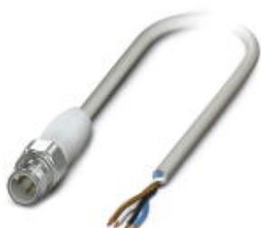
Кабель для датчика / исполнительного элемента, 4-полюсн., PP-EPDM без галогенов, серый RAL 7035, Штекеры прямое M12, А-кодирование, к свободный конец, длина кабеля: 1,5 м, Гигиеничный дизайн, с накатанной гайкой из легированной стали
