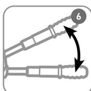
Разрежьте кабель, работая подвижной рукояткой. По окончании работы задвиньте рукоятки.
