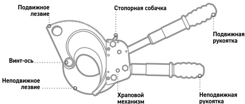
Ножницы секторные состоят из лезвий подвижного и неподвижного, храпового механизма, стопорной собачки и телескопических рукояток.
