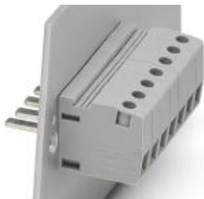
Проходная клемма, тип подключения: Винтовые зажимы, Подключение пайкой, полюсов: 1, ток нагрузки: 63 А, сечение: 0,5 мм<sup>2</sup> - 16 мм<sup>2</sup>, AWG 20 - 6, угол между направлениями подключения провода и установки разъема: 0°, ширина: 10,1 мм, цвет: серый
