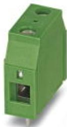
Клеммы для печатной платы, номинальный ток: 41 А, номинальное напряжение: 320 В, размер шага: 7,5 мм, полюсов: 4, тип подключения: Винтовой зажим с натяжной гильзой, монтаж: Пайка волной припоя, направление подключения, проводник/печатная плата: 0°, цвет: зеленый
