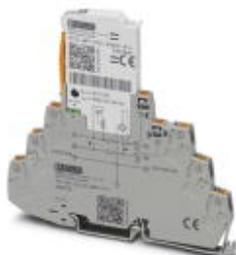
Устройство защиты от перенапряжений (защитный штекер и базовый элемент) со встроенным индикатором состояния и ножевыми размыкателями для 2-проводной сигнальной цепи Ex-i без потенциала земли, например токовых контуров 0(4) ... 20 mA, совместимость с HART.
