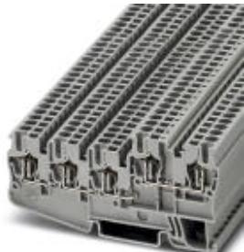
Клеммный модуль для подключения датчиков и исполнительных элементов, номинальное напряжение: 250 В, номинальный ток: 18 А, тип подключения: Пружинный зажим, количество точек подсоединения: 5, сечение: 0,08 мм<sup>2</sup> - 4 мм<sup>2</sup>, AWG: 28 - 12, ширина: 5,2 мм, цвет: серый, тип монтажа: NS 35/7,5, NS 35/15
