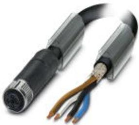
Силовой кабель, 4-полюсн., PUR без галогенов, черный RAL 9005, экранирован. (Advanced Shielding Technology), свободный конец, к Гнездо прямое M12, Т-кодирование, длина кабеля: 1,5 м
