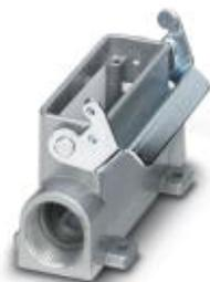
Приборный корпус D25, с одной защелкой, материал: Алюминиевое литье под давл., длина кабеля: 1, слева (вид на открытую плоскую скобку), высота: 57 мм, кабельный ввод: без, патрубков: да, 1x Pg21
