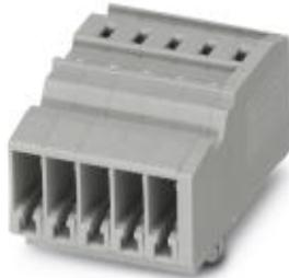
Соединитель COMBI, номинальное напряжение: 500 В, номинальный ток: 24 А, тип подключения: Пружинный зажим, количество точек подсоединения: 1, полюсов: 5, сечение: 0,08 мм<sup>2</sup> - 4 мм<sup>2</sup>, AWG: 28 - 12, ширина: 26 мм, высота: 21,8 мм, цвет: серый, тип монтажа: на монтажную пластину
