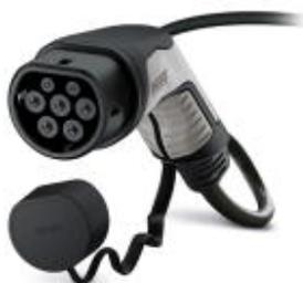
Зарядный кабель перем. тока с автомобильным зарядным штекером, без разъема, с защитным колпачком, C-Line черный / серый, Тип 2, МЭК 62196-2, 32 А / 480 В (AC), тип конструкции C-Line, кабель: 4 м, черный, прямой, поверхность сопряжения: черный, область захвата: серый
