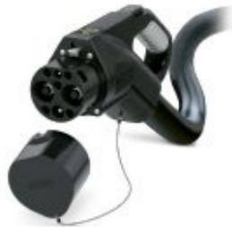
Зарядный кабель пост. тока с автомобильным зарядным штекером, без разъема, с защитным колпачком, GB/T, GB/T 20234.1-2015, GB/T 20234.3-2015, 250 А / 1000 В (DC), тип конструкции Стандартный, кабель: 4 м, черный, прямой, поверхность сопряжения: черный, область захвата: серый
