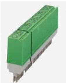
Релейный модуль с круглым миниреле Hengstler, материал контактов (AgSnO<sub>2</sub>+Au): для коммутации различных нагрузок (от небольших до больших), 4 переключающих контакта, входное напряжение 24 В DC, со световым индикатором, устанавливается на блоки базовых клемм
