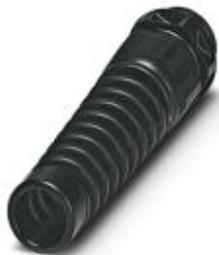
Кабельный ввод, материал резьбового соединения: PA, применение: Стандартн., наружный диаметр кабеля 9 мм ... 17 мм, экранировка: нет, резьба соединительной части: M25 x 1,5, цвет: иссиня-чёрный RAL 9005, с защитой от излома
