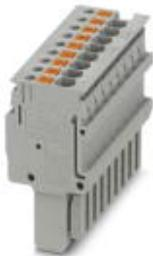
Штекер, номинальное напряжение: 500 В, номинальный ток: 17,5 А, тип подключения: Зажимы Push-in, количество точек подсоединения: 9, полюсов: 9, сечение: 0,14 мм<sup>2</sup> - 1,5 мм<sup>2</sup>, AWG: 26 - 14, ширина: 31,5 мм, высота: 31,3 мм, цвет: серый
