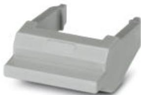
Крышка BRIDGE COVER используется с переключателями CONTACTRON для закрытия неиспользуемых разъемов, предусмотренных для потенциального расширения установки. Крышка может использоваться с переключателями как с винтовыми зажимами, так и с зажимами Push-in.
