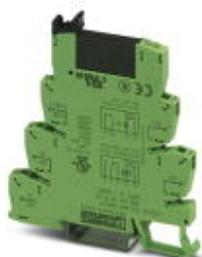
PLC-INTERFACE, состоит из основной клеммы PLC-BSP.../21 с пружинным зажимом и вставным миниатюрным полупроводниковым реле, для монтажной рейки NS 35/7,5, 1 замыкающий контакт, вход: 24 В DC, выход: 3-48 В DC/ 100 мА
