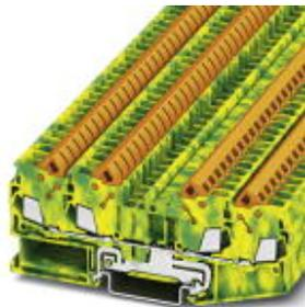
Клемма защитного провода, тип подключения: Быстрое подключение, количество точек подсоединения: 4, сечение: 0,5 мм<sup>2</sup> - 2,5 мм<sup>2</sup>, AWG: 20 - 14, ширина: 6,2 мм, высота: 37,8 мм, цвет: желто-зел., тип монтажа: NS 35/7,5, NS 35/7,5
