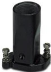
Сальниковый корпус D7, с шестигранным шлицевым винтом, материал: Цинк. литье под давлением, длина кабеля: 1, прямое, высота: 60 мм, кабельный ввод: без, патрубок: Нет, 1x M25, защитная крышка: Нет, для железнодорожного транспорта, для повышенных требований окружения и ЭМВ, Серия HPR
