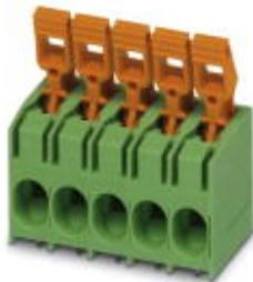
Клеммы для печатной платы, номинальный ток: 76 А, номинальное напряжение: 400 В, размер шага: 10 мм, полюсов: 4, тип подключения: Пружинный зажим Push-Lock, монтаж: Пайка волной припоя, направление подключения, проводник/печатная плата: 0 °, цвет: зеленый
