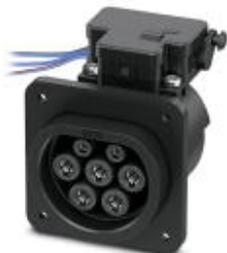
Инфраструктурная зарядная розетка для зарядки электромобилей переменным током (AC), совместима с инфраструктурными зарядными штекерами, Тип 2, МЭК 62196-2, 20 А / 480 В (AC), 24 В Блокирующий исполнительный элемент, отдельные жилы, длина: 0,7 м, Монтаж на задней панели, Привинчивание защитной крышки с задней стороны
