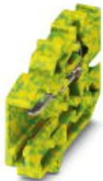
Соединитель COMBI, номинальное напряжение: 500 В, номинальный ток: 24 А, тип подключения: Пружинный зажим, количество точек подсоединения: 1, полюсов: 1, сечение: 0,08 мм<sup>2</sup> - 4 мм<sup>2</sup>, AWG: 28 - 12, ширина: 5,2 мм, высота: 21,8 мм, цвет: желто-зел., тип монтажа: на монтажную пластину
