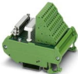
Модуль VARIOFACE с пружинными зажимами и гнездовым миниразъемом D-Sub, устанавливается на монтажную рейку NS 35/7,5 или NS 32, количество контактов 25
