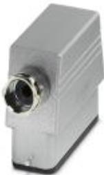
Корпус с кабельным сальником, крепление производится одной защелкой, высота 72 мм, с резьбовым соединением, 1x Pg16, подключение кабеля сбоку
