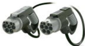
Мобильный зарядный кабель перем. тока с автомобильным зарядным и инфраструктурным штекерами, с защитными колпачками, Designlinie 1, GB/T, GB/T 20234.2, 32 A / 250 В (AC), тип конструкции D-Line, кабель: 5 м, черный, прямой, поверхность сопряжения: серый, область захвата: серый
