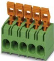
Клеммы для печатной платы, номинальный ток: 76 А, номинальное напряжение: 1000 В, размер шага: 10 мм, полюсов: 7, тип подключения: Пружинный зажим Push-Lock, монтаж: Пайка волной припоя, направление подключения, проводник/печатная плата: 0 °, цвет: зеленый
