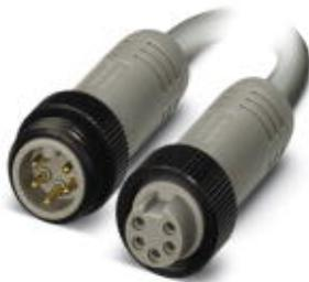
Системный кабель шины, DeviceNet™, 5-полюсн., ПВХ, серый, Штекеры прямое 7/8"-16UNF, A - стандарт, к Гнездо прямое 7/8"-16UNF, A - стандарт, длина кабеля: 10 м
