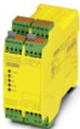
Реле безопасности для контроля аварийного останова и защитной дверцы до SIL 3 или кат. 4, PL e согласно EN ISO 13849, автомат. или ручная активация, 3 замык. контакта, 1 размык. контакт, 2 замык. контакта с задержкой отключения 0,5 сек, втычная пружинная клемма
