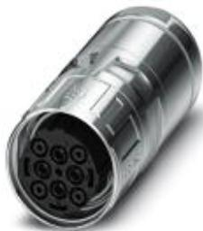
Кабельный соединитель, прямой, Крепление SPEEDCON, M40, полюсов: 4+3+PE, тип контактов: Розетка, Обжим, экранирован.: есть, диапазон диаметра кабеля: 20,5 мм ... 26,5 мм
