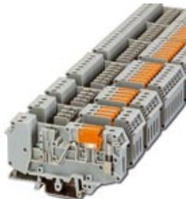
Блоки базовых клемм, с обеих сторон расположены гнезда для подключения щупа тестера и ножевые разъединители, устанавливаются на монтажные рейки NS 32 и NS 35/7,5, с концевой крышкой, для штекерных модулей ST-REL..., ST-OV... и ST-OE..., 2-полюсные
