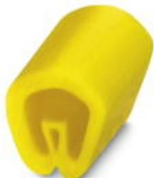
Маркировочные кольца для проводников, желтый: без надписи, тип монтажа: нанизывание, диапазон диаметра кабеля: 1,4 ... 2,5 мм, размер маркировочного поля: 3,2 x 2,6 мм
