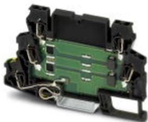
Клеммный блок с пружинными зажимами, со встроенной защитой от импульсных перенапряжений, для монтажа на NS 35/7.5, напряжение  $U_N$  24 В DC, ширина клеммного модуля: 6,2 мм, ширина крышки: 2,2 мм
