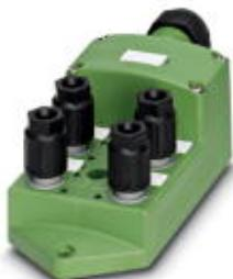
Коробка датчика и исполнительного элемента, применение: Стандартн., тип подключения: QUICKON, 0,14 мм<sup>2</sup> ... 0,34 мм<sup>2</sup>, количество гнезд: 4, полюсов: 4, гнездо для платы: Двойной, индикатор состояния: есть, р-п-р; подключение магистрального кабеля: вставные винтовые клеммы 180°, экранировка: нет
