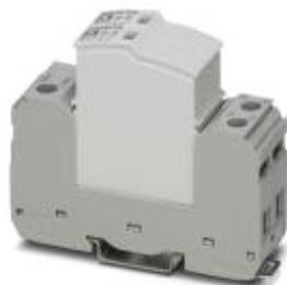
Вставное устройство защиты от перенапряжений, тип 2 / класс II, для 2-фазных цепей электропитания с совмещенными в одном проводе проводниками PE и N (3-проводная система: L1, L2, PEN).
