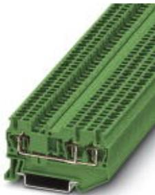
Проходные клеммы, номинальное напряжение: 500 В, номинальный ток: 17,5 А, тип подключения: Пружинный зажим, количество точек подсоединения: 3, сечение: 0,08 мм<sup>2</sup> - 1,5 мм<sup>2</sup>, AWG: 28 - 16, ширина: 4,2 мм, цвет: зеленый, тип монтажа: NS 35/7,5, NS 35/15
