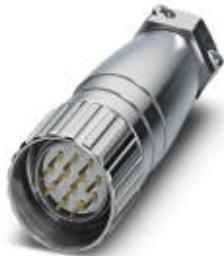
Кабельный соединитель, соединительная часть с резьбой Pg13,5, прямой, экранирован.: есть, Винтовой зажим, M23, Полясов: 11+PE, тип контактов: Штифт, Подключение пайкой, диапазон диаметра кабеля: 3 мм ... 10,5 мм
