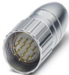
Кабельный соединитель, прямой, экранирован.: есть, Винтовой зажим, M23, Полосов: 8+1, тип контактов: Штифт, Подключение пайкой, диапазон диаметра кабеля: 7,5 мм ... 9,5 мм
