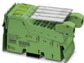
Inline, Клемма аналогового ввода, Аналоговые входы: 2, 4 мА ... 20 мА, 0 мА ... 25 мА, способ подключения: 2-проводная схема, скорость передачи данных в локальной шине: 500 кбит/с, Функциональность HART, Протокол передачи данных HART, степень защиты: IP20, включая штекеры Inline и поля для маркировки
