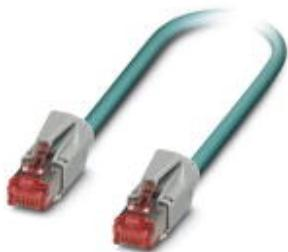
Готовый Ethernet-кабель, CAT5e, экранированный, 2 пары, гибкий AWG 26 (7-проводочный), RAL 5021 (цвет морской воды), разъемы RJ45/IP20 и RJ45/IP20, прямая разводка, длина 0,3 м
