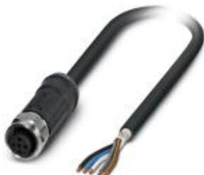
Кабель для датчика / исполнительного элемента, 5-полюсн., PE-X/PE-X без галогенов, темно-серый RAL 7021, экранирован., свободный конец, к Гнездо прямое M12, A-кодирование, длина кабеля: 5 м, для применения вне помещений, с накатанной гайкой из легированной стали
