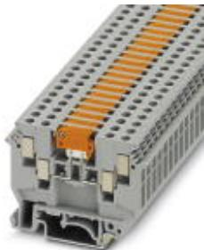
Клеммы с ножевыми размыкательями, с закрытым клеммным пространством и винтами для крепления контрольного штекера, номинальное напряжение: 630 В, номинальный ток: 16 А, тип подключения: Винтовые зажимы, сечение: 0,2 мм<sup>2</sup> - 6 мм<sup>2</sup>, AWG: 24 - 10, длина: 63,5 мм, ширина: 6,2 мм, цвет: серый, монтаж: NS 35/7,5, NS 35/15, NS 32, номинальное напряжение: 630 В
