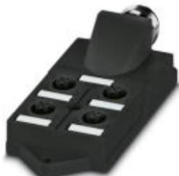
Коробка датчика и исполнительного элемента, применение: Стандартн., тип подключения: Розетка M12 Пластик, количество гнезд: 4, полюсов: 5, механические ключи: А - стандарт, гнездо для платы: Двойной, индикатор состояния: Нет, Универсальный; подключение магистрального кабеля: Штекерный разъем M 23 180°, экранировка: нет
