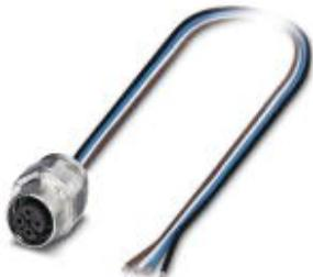
Встраиваемый гнездовой разъем датчика / исполнительного элемента, 4 контактов, M12 SPEEDCON, с механическим ключом типа А, фронтальный монтаж, резьбовая часть М16, позиционируемый, с гибким кабелем TPE длиной 0,5 м, 4 x 0,25 мм<sup>2</sup>
