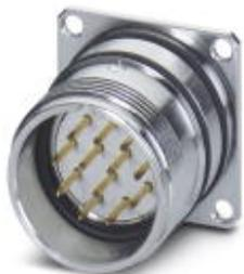
Приборный соединитель, задняя часть стенки, прямой, экранирован.: есть, Винтовой зажим, M23, Полюсов: 16+3, тип контактов: Штифт, Подключение пайкой, Радиальное уплотнительное кольцо, 4xM2,5, Толщина стенок, мин.: 2,7 мм, Толщина стенок, макс.: 3,5 мм
