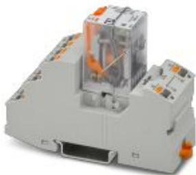
Предустановленный релейный модуль с разъемами push-in, состоящий из базового модуля, реле с силовыми контактами с дополнительным твердым позолоченным покрытием и металлическим держателем. Исполнение контактов: 4 переключающих контакта. Входное напряжение: 230 В AC
