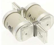
Предохранитель, высокая скорость, 355 А, перем. ток 690 В, пост. ток (DC) 350 В, BS88, 83 x 113 мм, aR, BS
